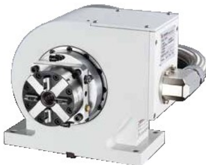
▲ 快速裝夾治具客製化介面, 圖例為EROWA夾頭
