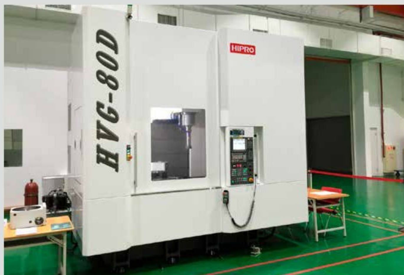
獨家採用立式液靜壓軸承磨床
